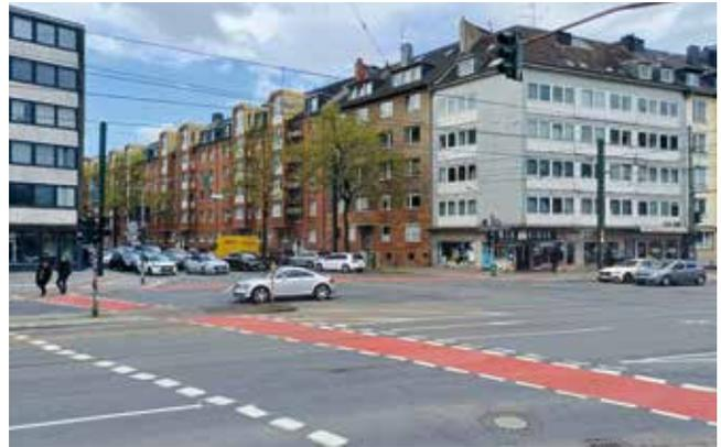
**An 13 signalgeregelten Verkehrsknotenpunkten entlang des Lastring, an denen der Radverkehr gleichzeitig mit dem parallel laufenden Autoverkehr Grün hat, wurden vorhandene Radverkehrsfurten rot eingefärbt.** – Foto: Landeshauptstadt Düsseldorf
